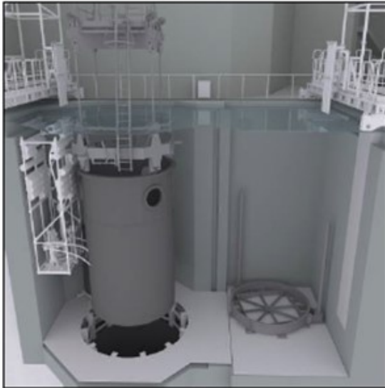
Ausheben des Unteren Kerngerüsts
