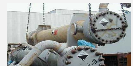
Abb. 6: Komponenten aus der Gasindustrie kontaminiert mit Quecksilber
