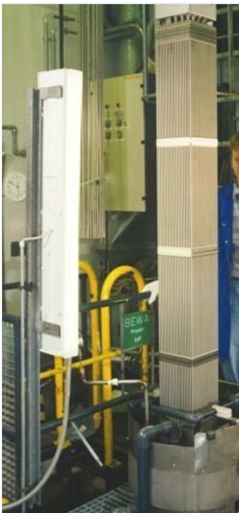
Reinigung eines DWR-Brennelements in der Waschanlage
